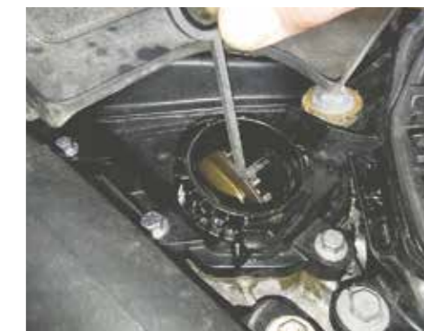
Das Zahnriemenkontrollwerkzeug wird durch die Öleinfüllöffnung nach unten in Richtung Zahnriemen geführt
