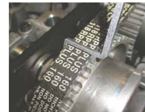
Solange die Breite des Zahnriemens die Breite des Zahnriemensteuerwerkzeugs zwischen den Backen nicht überschreitet, ist der Zahnriemenzustand in Ordnung
