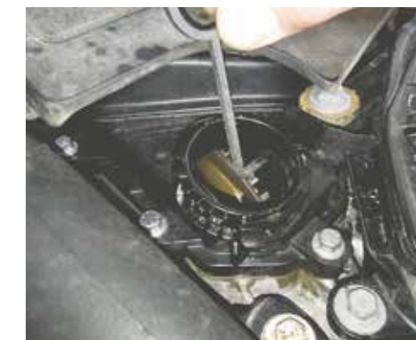
Tandremskontrolværktøjet føres ned mod tandremmen gennem oliepåfyldningshullet
