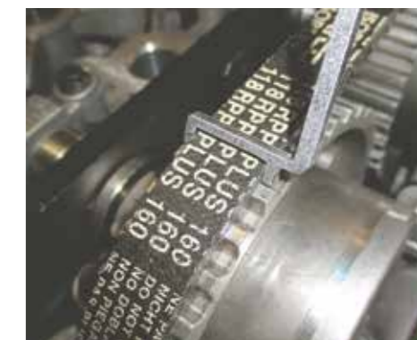
Så længe tandremmens bredde ikke overskrider tandremskontrolværktøjets bredde mellem kæberne er tandremmens tilstand OK
