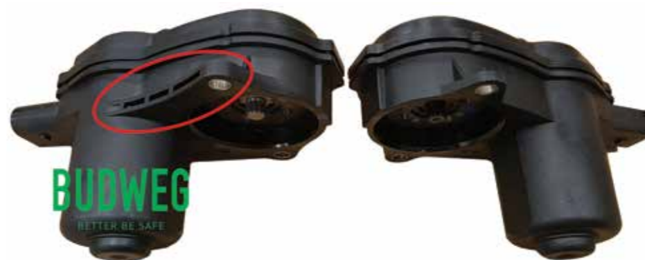
Den forstærkende finne på Budwegs EPB-motor (se rød markering) tilføjer mere struktur og stabilitet til de områder på huset, som bliver udsat for den højeste grad af mekaniske kræfter
