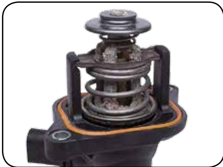
Abb. 1 MAP kontrolliert ein Thermostat mit deutlichen Anzeichen an Korrosion (Bild: Mahle)
