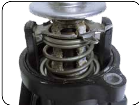
Abb. 2 Ein Thermostat bei dem ein unsachgemäßes Kühlmittel verwendet wurde. Dies hat dazu geführt, dass das Aluminium „weggeätzt“ wurde (Bild: Mahle)
