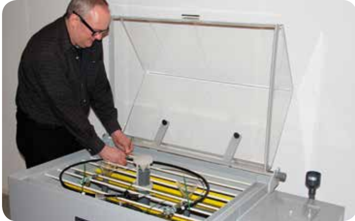
Triscans neue Salzsprühkammer für beschleunigte Lebensdauerprüfung von Korrosionsschutz
