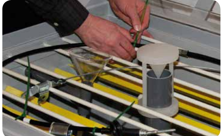
Hier wird ein Handbremsseil für ein Korrosionsschutztest vorbereitet.
