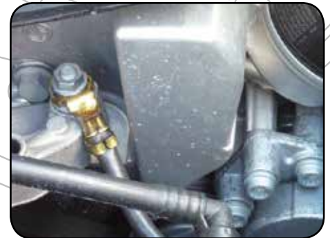
Abb. 3 Versichern Sie sich, dass das Erdungskabel intakt – und korrekt angeschlossen ist (Bild: Mahle)
