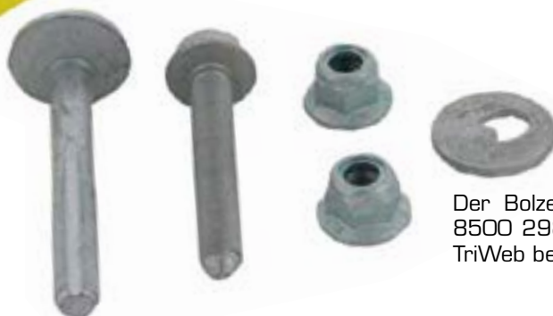
Triscan Referenz 8500 298001 – Bolzensatz für den hinteren VAG Querlenker – Triscan Ref. 8500 295029
