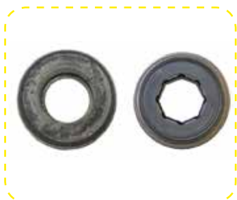
Vergleich: Dichtungsring links mit deutlichen Spuren von verunreinigter Kühlflüssigkeit
