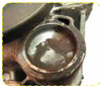
Undichte Wasserpumpe mit Spuren von verunreinigter Kühlflüssigkeit
