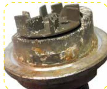
Undichte Wasserpumpe mit Spuren von Kalk im Kühlsystem
