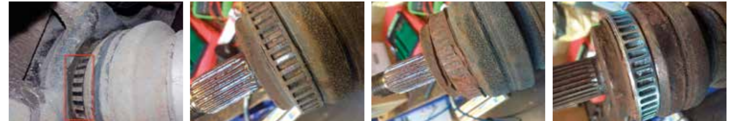
Billeder af drivaksel med defekt og OK abs-ring (Autodata)
