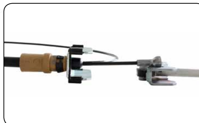
Forkert montering er umuliggjort med Triscans forbedrede bremsekabel
