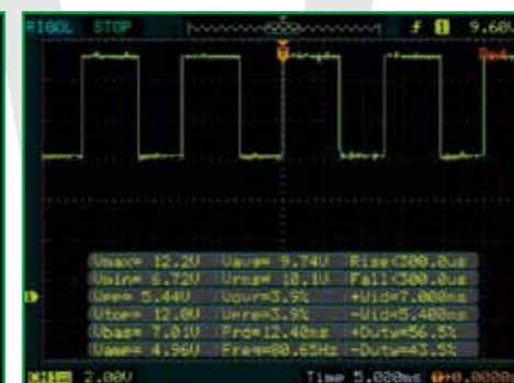
Her ses det rektangulære signal fra en enten aktiv eller induktiv ABS-sensor (hall effekt chip). Den aktive arbejder med magnetisk ABS-ring og den induktive med ABS-ring med tænder
