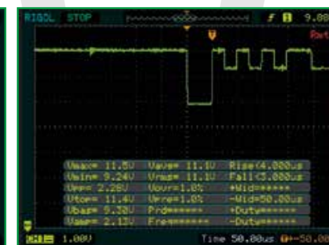
Her ses det rektangulære signal fra en ABS-sensor med hall effekt chip, som er i stand til at tælle tænder og registrere hjulets rotationsretning
