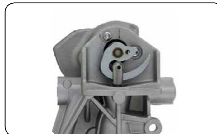
På billederne ses tydeligt hvorledes udstødningsgassen er trængt ind og har tilsødet kammeret og delene som indgår i ventilstyringsmekanismen
