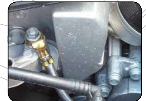
Man bør tjekke at jordkablet er intakt og korrekt tilsluttet (Foto lånt af Mahle)
