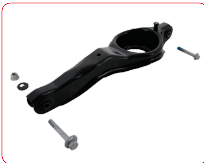
Her ses bærearmer med placering af monteringssettets enkelte dele
