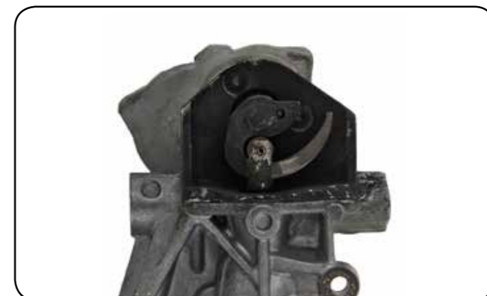
På billederne ses tydeligt hvorledes udstødningsgassen er trængt ind og har tilsødet kammeret og delene som indgår i ventilstyringsmekanismen
