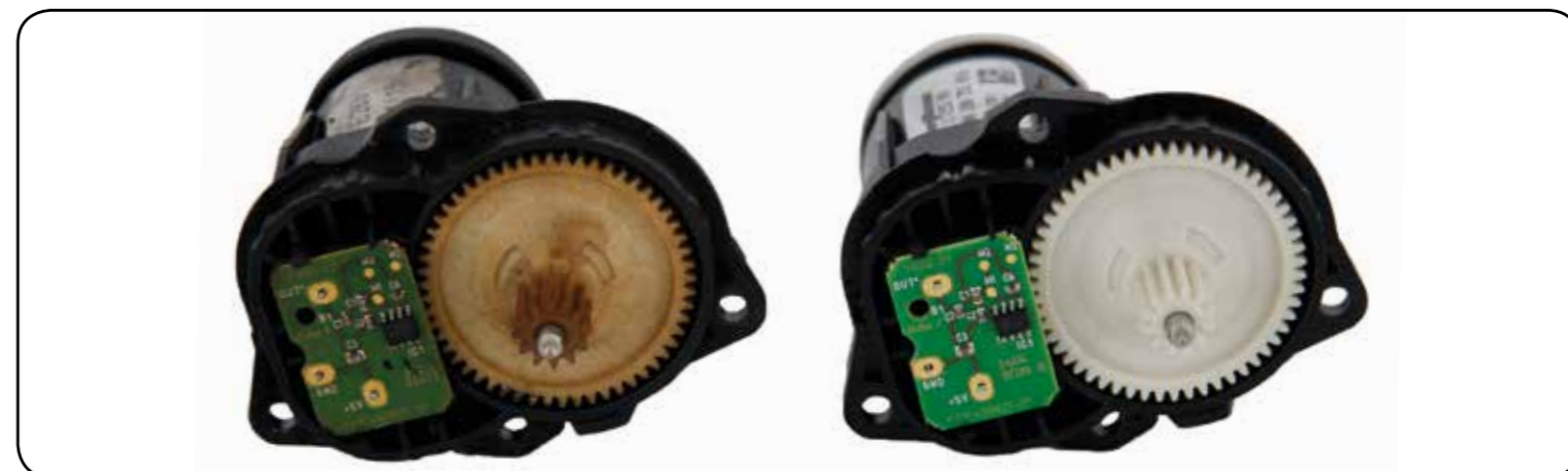
På billedet ses tydeligt hvorledes udstødningsgassen er trængt ind og har tilsødet printpladen og dens komponenter
