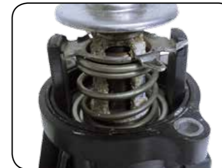
Termostat hvor der har været anvendt ikke-godkendt kølemiddel/additiv. Dette har bevirket, at aluminiumet er "ætses" væk (Foto lånt af Mahle)
