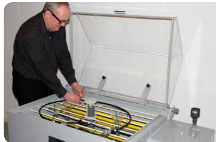
Triscans nye salttågekammer - for korrosionstest
