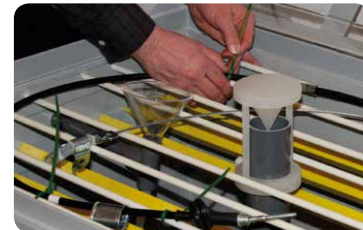
Her fastgøres et håndbremsekabel i salttågekammeret for test
