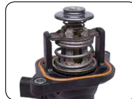
MAP kontrolleret termostat med tydelige tegn på korrosion (Foto lånt af Mahle)
