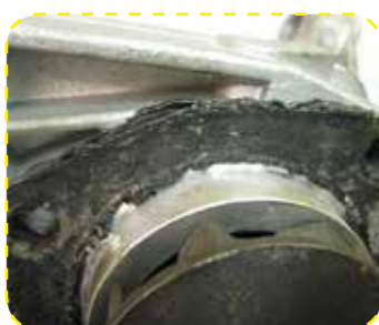
Vandpumpe med aflejringer af flydende pakning i kølesystemet
