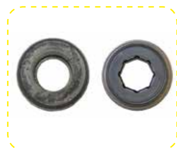
Sammenligning: Pakring til venstre med tydelige spor af forurenede kølevand
