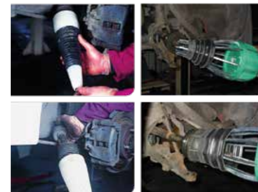
Montering sker hurtigt og uproblematisk ved hjælp af monteringskegle (Triscan ref. 8541 100) eller AIR-TOOL (Triscan ref. 8541 103).
