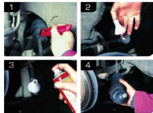
Tandstangsmanchetten monteres hurtigt og let – uden tilskæring
